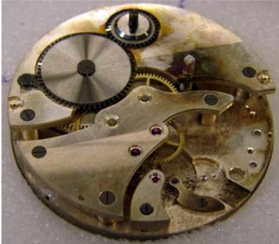
Vue de la montre ASSA, en cours de démontage, côté ponts. Pont de coq enlevé.
